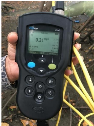
Anexo 6. Medición del oxígeno disuelto In situ
