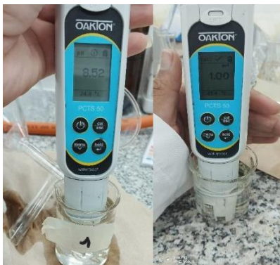
Anexo 10. Medición de ph, y salinidad con el equipo multiparámetro oaklon pcts50 del agua de las plantas
