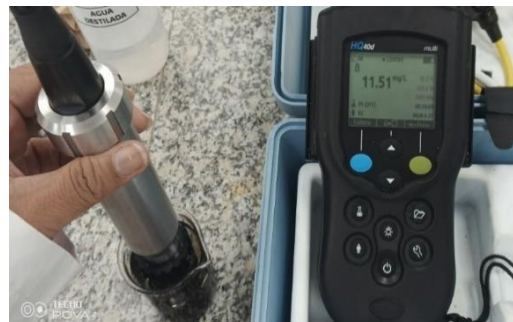
Anexo 11. Medición del oxígeno disuelto del agua de las plantas con el equipo multiparámetros HACH HQ40d
