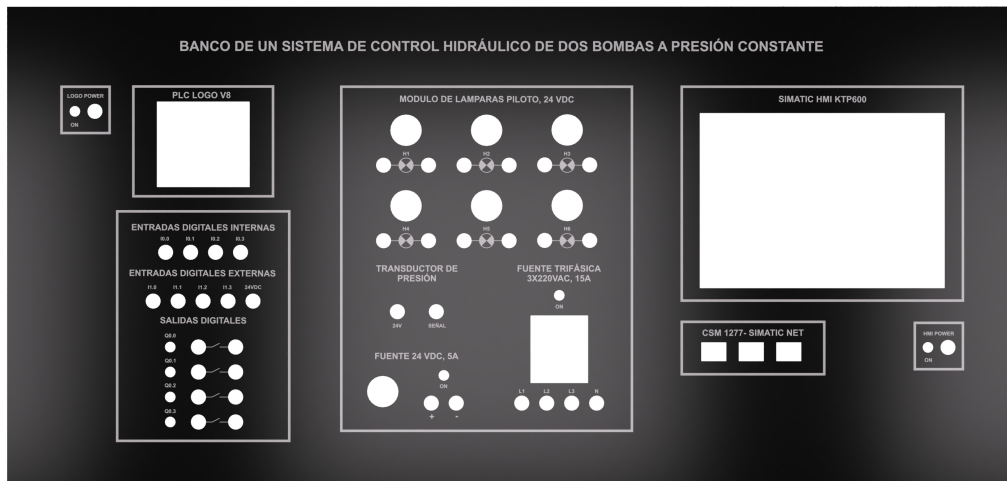
Figura 2.16: Diseño 3D del acrílico ubicado en la parte superior del banco experimental.
