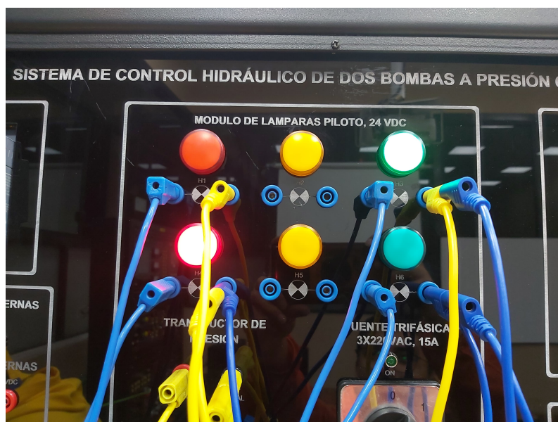
Figura 3.6: Bomba 1 activada y bomba 2 en reposo.
