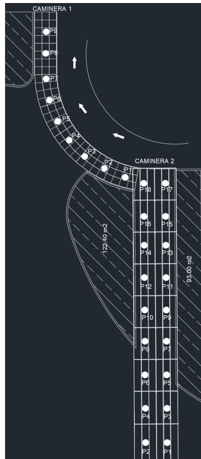
Figura 3.8: Puntos de medición de camineras Fuente: Autores
