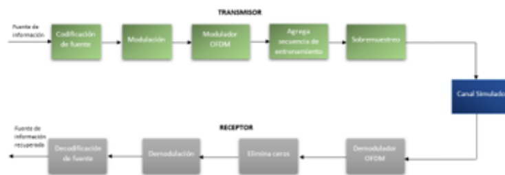
Figura 7 Diagrama de bloques completo sistema SISO OFDM
