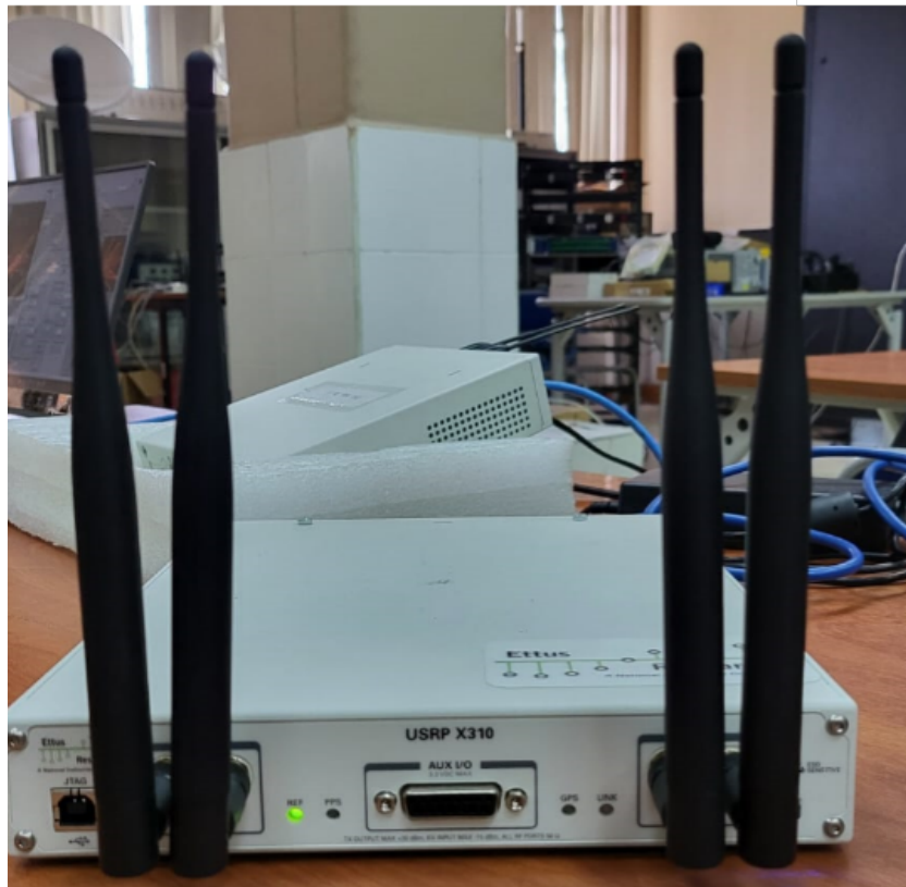
Figura 2.47: Equipos USRP ETTUS X310 del laboratorio de Telecomunicaciones de la Sede Cuenca. Fuente: Los Autores
