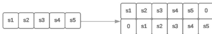
Figura 2.45: Diagrama de bloque multiplexación D-Blast. Fuente: Los Autores
