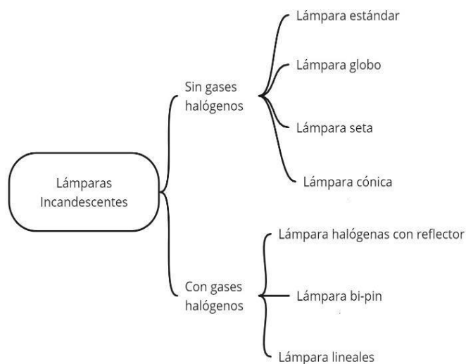
Ilustración 25, Tipos de lámparas incandescentes [62]
