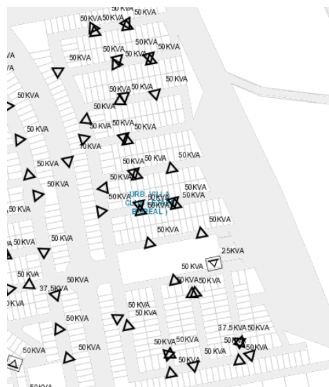
Ilustración 27, Ubicación de transformadores 'geoportal'
