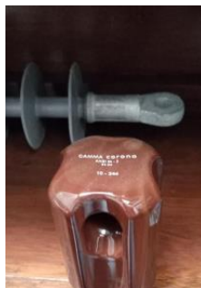
Ilustración 4., Material polimérico utilizado como sujeta y aislante de tensor. (CNEL EP--2022)
