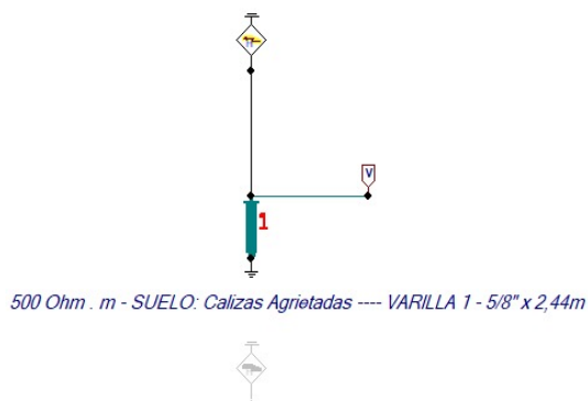
Figura 84. Varilla 1 de 2,44m de 5/8" - Caliza agrietada Adaptación: Autores
