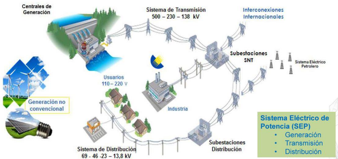
Figura 4. Sistema de distribución. [8].
