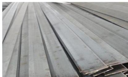
Las platinas son piezas metálicas planas y anchas, generalmente de forma rectangular, utilizadas en construcción y manufactura para brindar soporte estructural.
