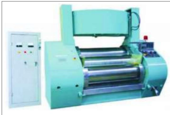
**Nota:** En la Figura se observa la maquina que usa rodillos para moler el cacao [11].
