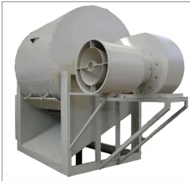
**Nota:** En la Figura se observa la maquina secadora Tipo Guardiola y como esta compuesta [20].
