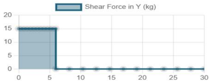
Figura 18 Diagrama de fuerzas cortantes correspondientes al eje de la falange
