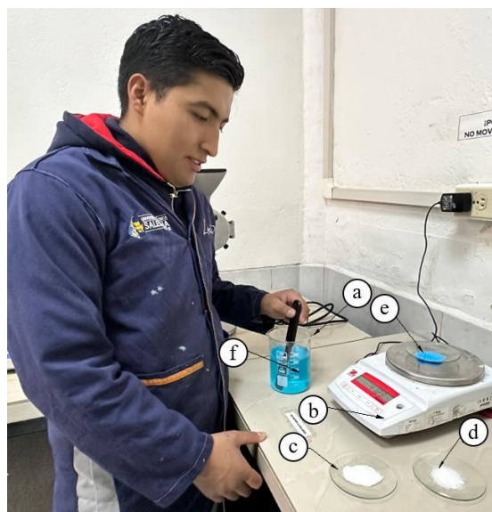
Figura 5. Preparación de los electrolitos: Vaso de precipitación (a), balanza (b), ácido cítrico (c), cloruro de sodio (d), pesaje de sulfato de cobre (e) y electrolito (f)
