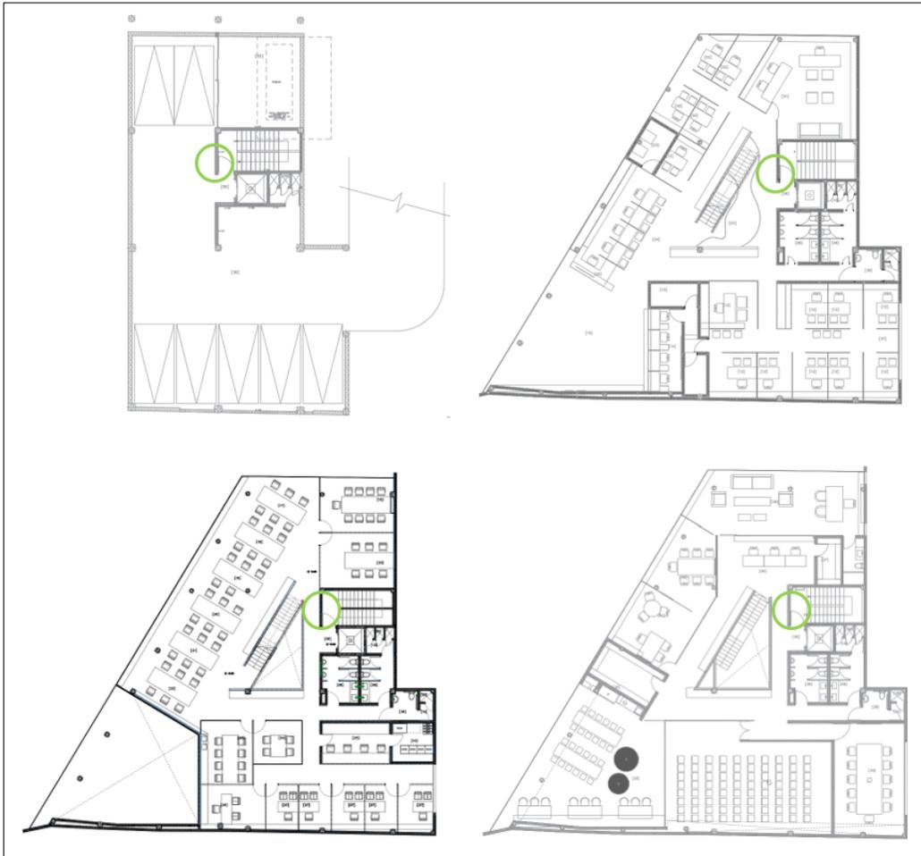
El requerimiento de caudal para esta clase de gabinete es de 100 Gpm como mínimo, para el gabinete hidráulicamente más lejano y una presión de 65 psi, en este caso este gabinete estará ubicado en la segunda planta. Para la simulación y recaudación de los datos se utilizó el software Pipe Flow.
