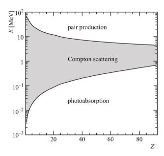
Nota. La curva inferior muestra, según el número atómico Z del material, la energía fotónica E por debajo de la cual la absorción fotoeléctrica es el mecanismo de interacción, mientras que la curva superior muestra la energía superior de la cual el proceso más importante. La región sombreada región sombreada entre las dos curvas corresponde al dominio en el que domina la dispersión Compton. Las secciones transversales se han tomado de la base de datos XCOM del NIST (Bichsel & Schindler, 2020).
