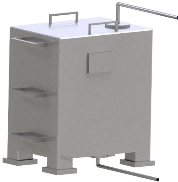
Figura17: Diseño final del tanque de almacenamiento.
