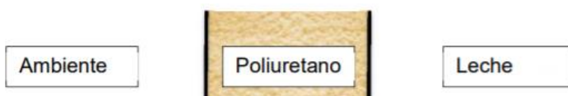
Figura 14: Poliuretano como aislante térmico entre las paredes del tanque de almacenamiento [21].
