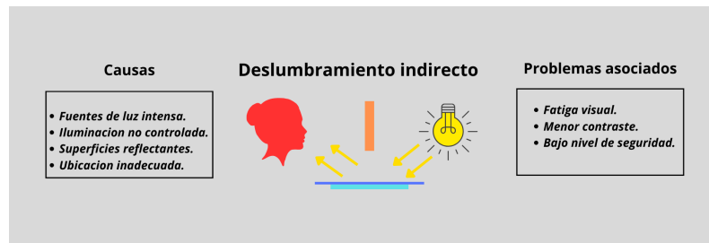
Figura 5.11: Deslumbramiento indirecto causas y problemáticas [1].
