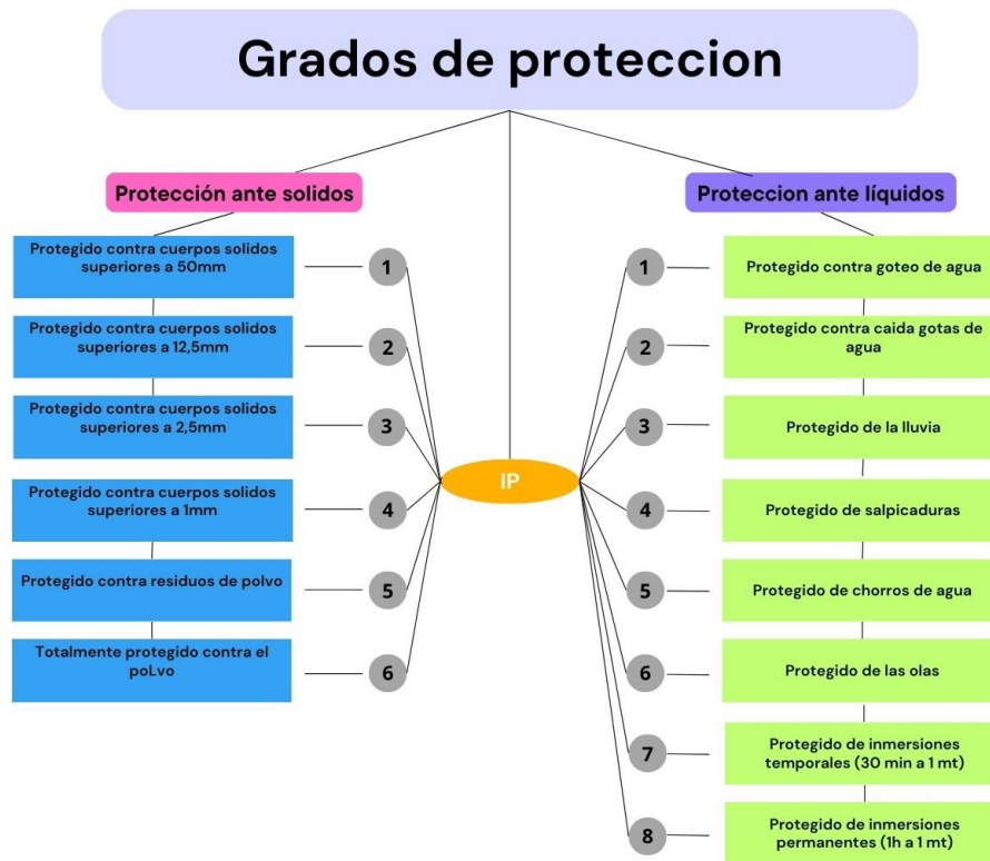
Figura 5.14: Grados de protección [1]
