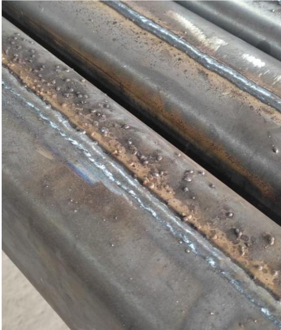
a) Superficie con proyecciones de soldadura. Deben ser removidos
