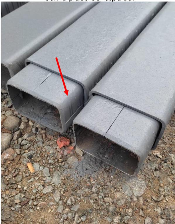
e) Vista ampliada del respaldo, esta placa debe ser continua sin interrupciones en las esquinas.
