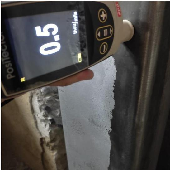
e) aplicación de una primera capa de recubrimiento, con un EPS de 0.5mil, con la capa final debe cumplir 1mil
