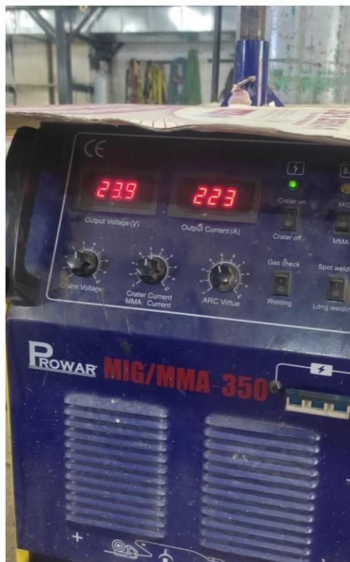
b) Verificación de parámetros eléctricos para junta de fabricación de columnas HSS.
