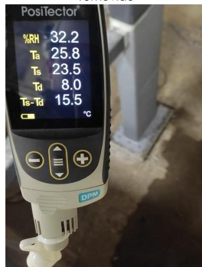
d) Verificación de condiciones ambientales. El último valor mostrado debe ser  $>3.0$  para la aplicación del recubrimiento
