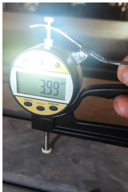
b) Verificación de espesores de HSS 100x100x4mm
