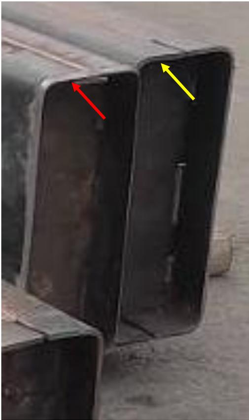
a) biselado de columna HSS para conexión Columna-Placa base se muestra con la flecha roja. Un bisel sin preparar se muestra con la flecha amarilla
