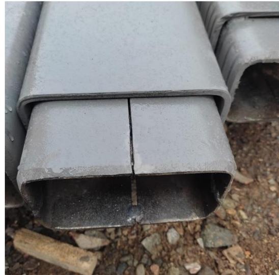
f) Se recubre el respaldo de la conexión Columna-Columna por las condiciones en las que se va a almacenar. Previo a los trabajos de soldadura el recubrimiento debe ser removido de esta zona.
