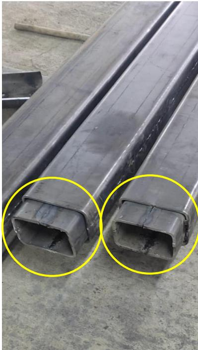
c) Preparación de la conexión Columna-Columna con la placa de respaldo.
