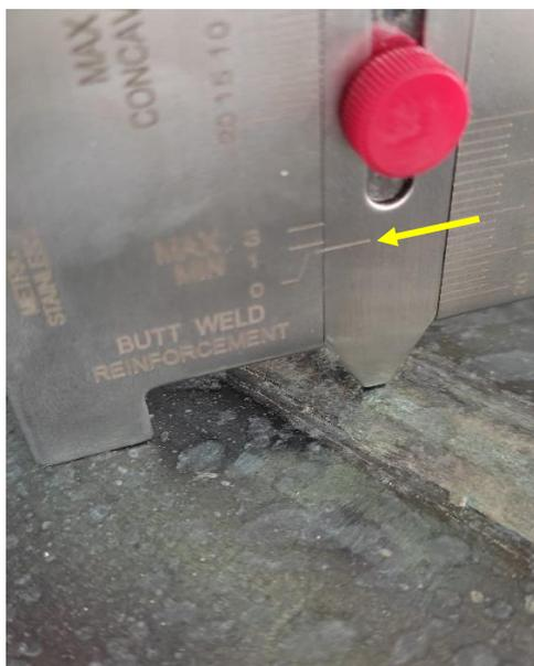
a) Medición de altura máxima de refuerzo. Para este caso el refuerzo es de 0mm
