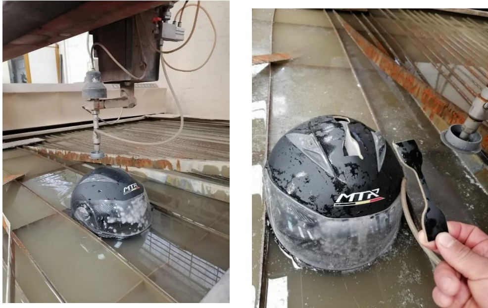
Figura 11: Corte de las probetas
