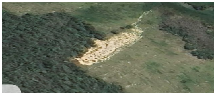
Figura 24 Deslizamiento traslacional en Cumbe.
