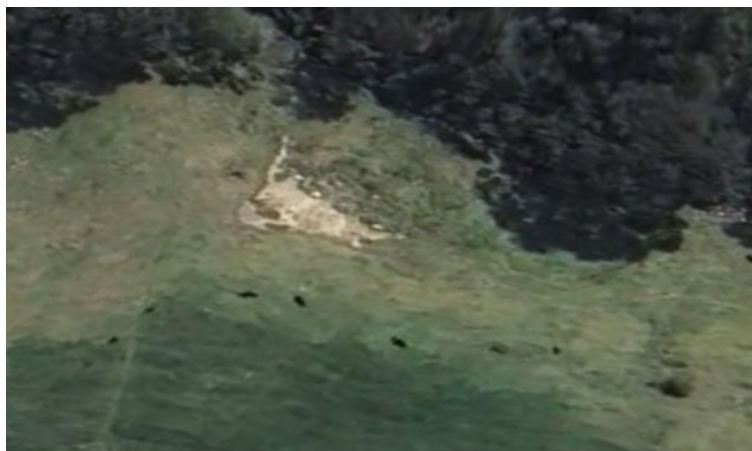
Figura 25 Deslizamiento de flujo lento.
