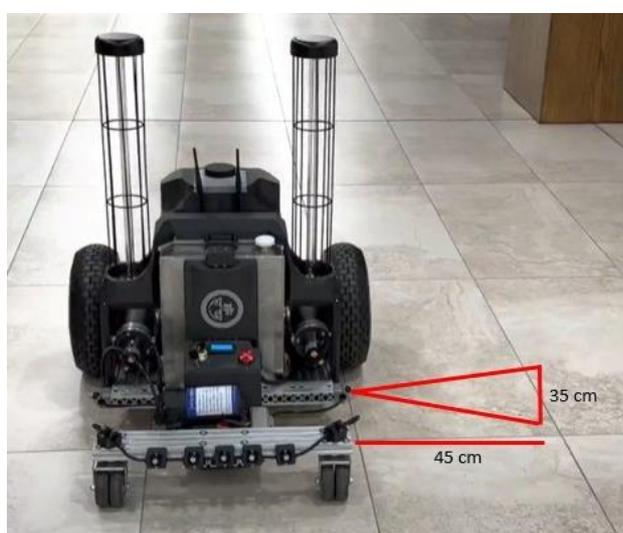
Figura 18. Imagen real del robot desinfectador (Investigación, 2021).
