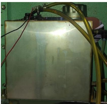
*Nota: Se trata de un tanque adaptado en el cuál va montada la bomba de combustible (Reinoso Méndez & Cabrera Jaramillo, 2023)*
