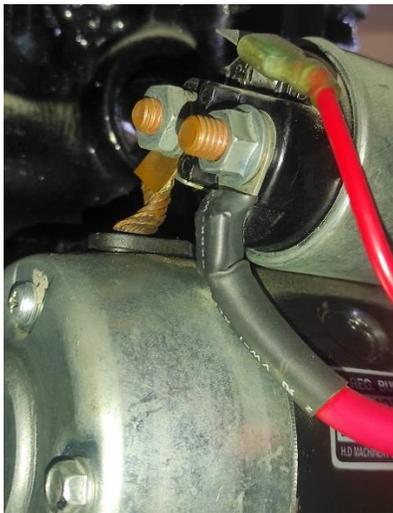
*Nota: Los cables se encuentran en buen estado para garantizar un flujo de corriente óptimo hacia el motor de arranque (12V). (Reinoso Méndez & Cabrera Jaramillo, 2023)*
