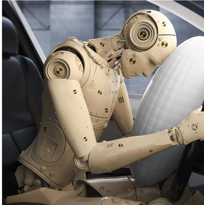
*Nota.* La imagen representa la finalidad del sistema airbag, el cual es amortiguar el golpe del conductor contra el volante. Tomado de (Baskar, 2023).
