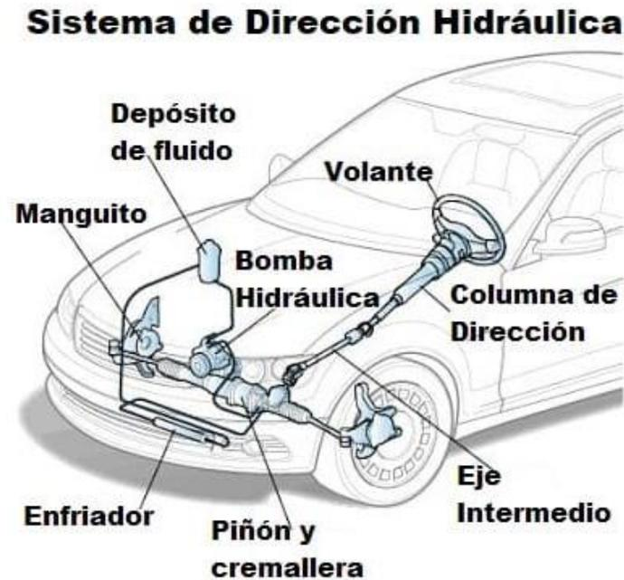
*Nota.* Utiliza fluido presurizado para facilitar el giro del volante vehicular, mejorando maniobrabilidad y confort. Tomado de (Mecánica Automotriz, 2023).
