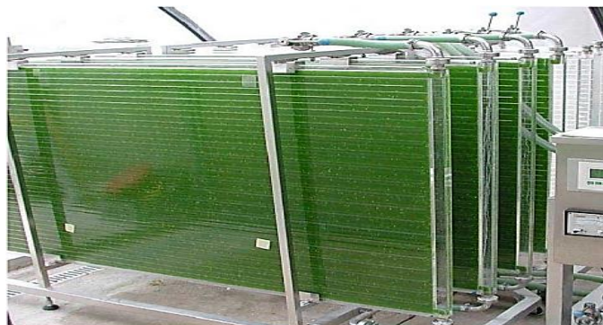
Figura 7. Fotobiorreactores de panel plano
