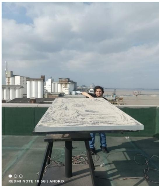
*Figura 154 Prueba de simulación de caída de cenizas en el panel fotovoltaico*
