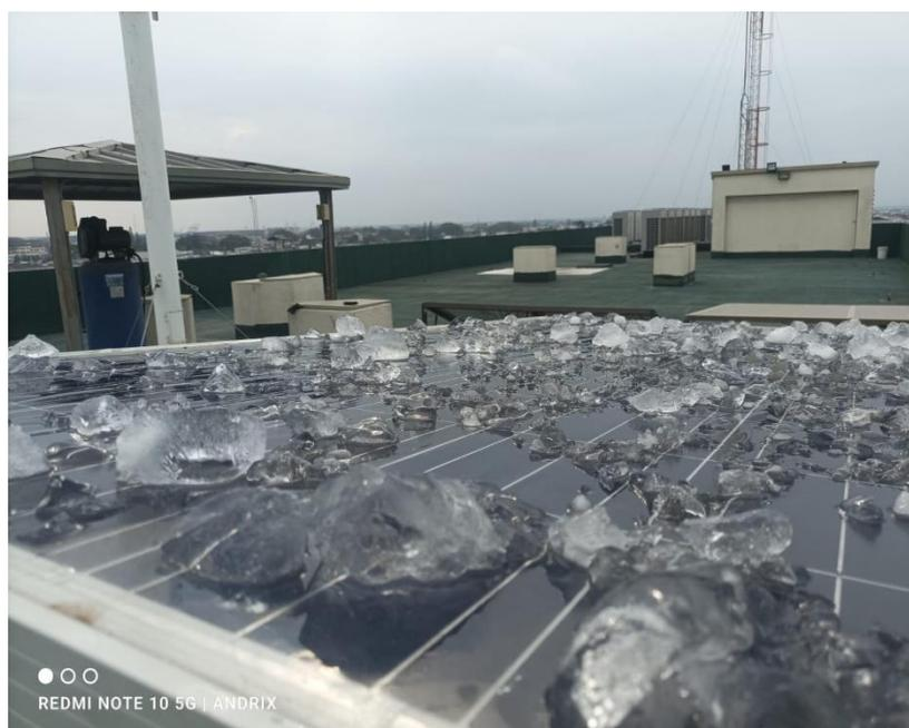
*Figura 155 Prueba de simulación de caída de nieve (hielo) en el panel fotovoltaico*
