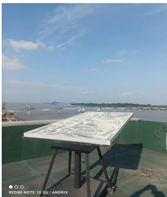
Figura 31 Panel fotovoltaico prueba de cenizas, [6]
