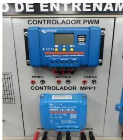
Figura 14 Controlador pwm y controlador mppt, [6]
