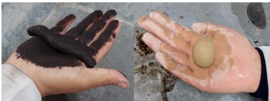
Figura 15. Análisis de la textura del suelo por método del tacto
