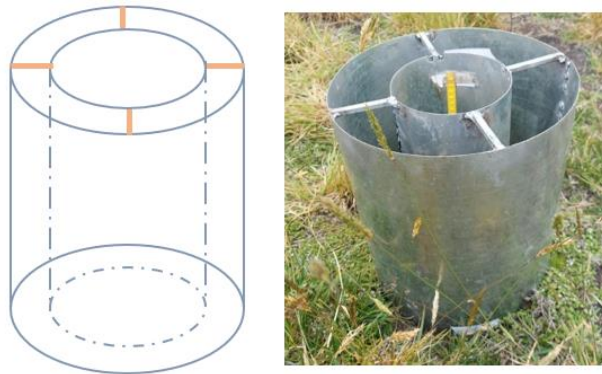
Figura 4. Infiltrómetro de doble anillo
