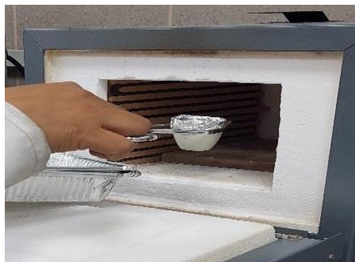
Figura 11. Calcinación de la materia orgánica en la mufla
