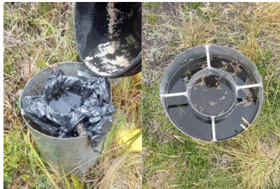
Figura 6. Llenado del infiltrómetro
