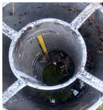
Figura 7. Infiltrómetro con cinta métrica
