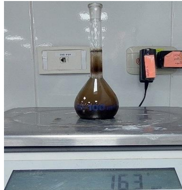
Figura 13. Estimación de la densidad real
