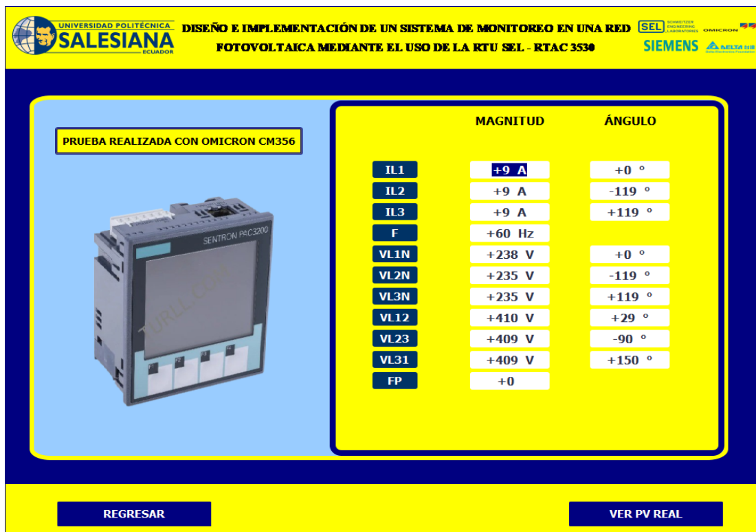
Figura 115. Lectura del Sistema SCADA en PAC 3200
