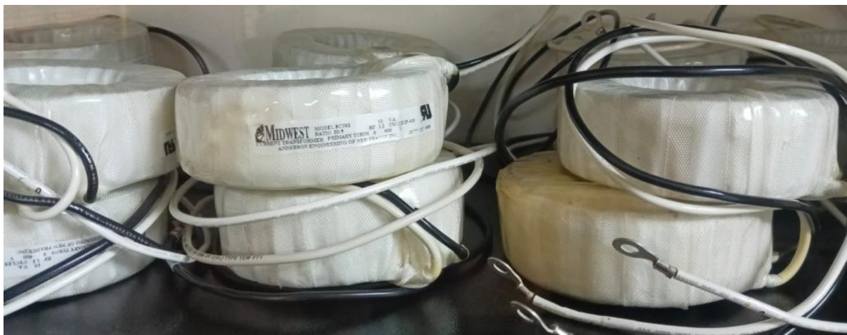
Figura 12. Transformadores de corriente
