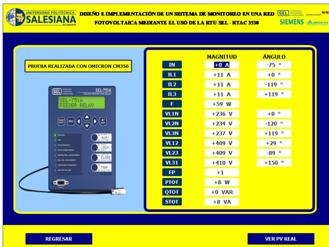
Figura 113. Lectura del Sistema SCADA en Relé SEL 751
