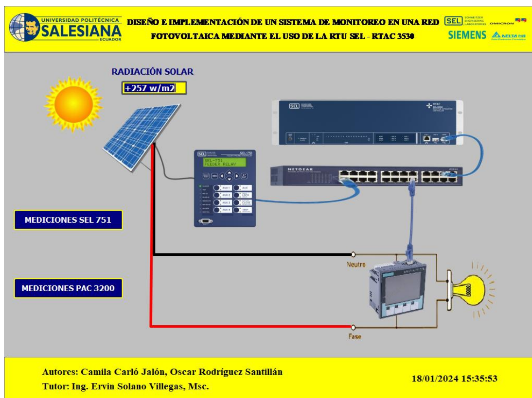
Figura 116. Pantalla principal SCADA con medición de Radiación Solar
