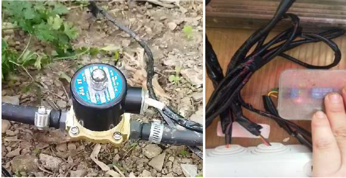
Figura 48 Válvula electromagnética y funcionamiento con el relé [Autor]
