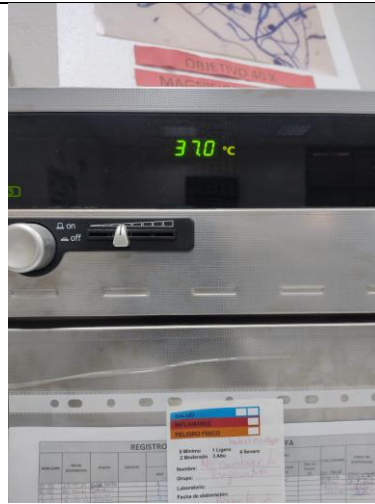
B: Incubadora con la temperatura de 37°C
