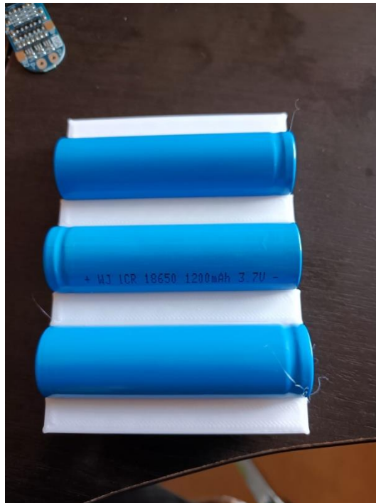
Figura 46. Pack de 3 Baterías Li-ion 18650.
