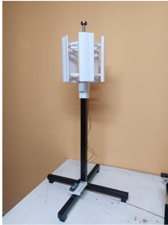
Figura 42. Montaje final del aerogenerador.
