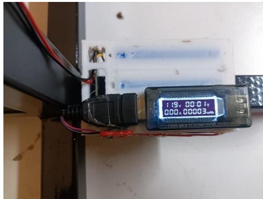
Figura 56. Medición del voltaje de generación.
