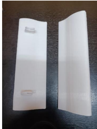
Figura 39. Impresión 3D de las aspas tipo NACA 0012.
