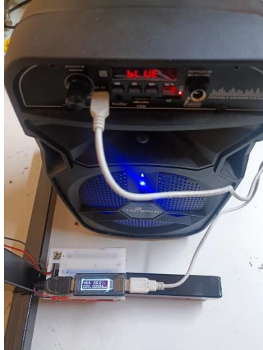
Figura 58. Conexión de la carga auditiva de 10W.
