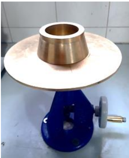
Figura 9. Ensayo de determinación del flujo en el mortero.
