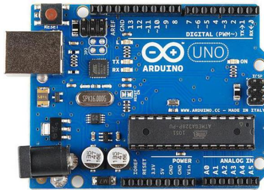
Figura 58. Arduino UNO R3[36]
