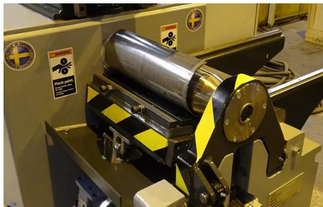
**Figura 4.** Máquina de prensado por rodillos [38].
