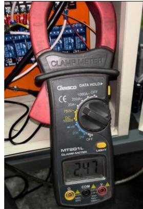
**Figura 27.** Medición de corriente en la conexión estrella triángulo.
