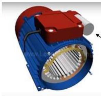
**Figura 8.** Motor monofásico [42].
