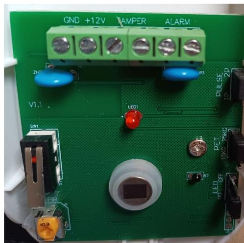
Posteriormente estos bornes se conectarán al microcontrolador esp32, se realizará la interconexión entre los pines 26 y GND del microcontrolador y los bornes de transmisión del sensor cableado a utilizar.
