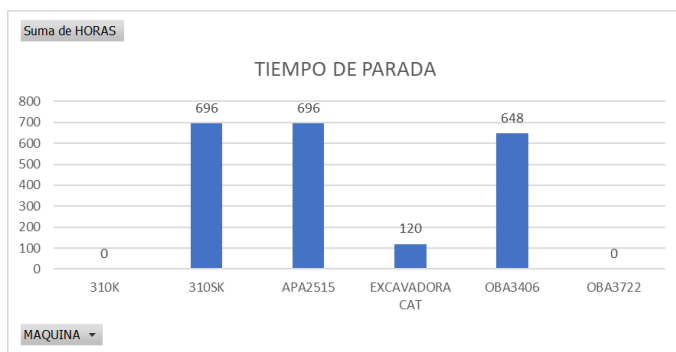
Figura 5. Tiempo de parada de los equipos de maquinaria pesada.
