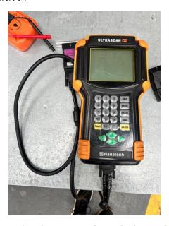
Nota: La figura presenta el escáner automotriz empleado para la comprobación de valores de voltaje emitidos por los sensores del motor. Fuente: Los autores
