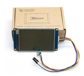
Nota: La figura presenta la pantalla táctil del 2.8 pulgadas utilizada en el proyecto, Fuente: Novatronic (https://novatronicec.com/index.php/product/pantalla-nextion-nx3224t028-2-8-inch/)
