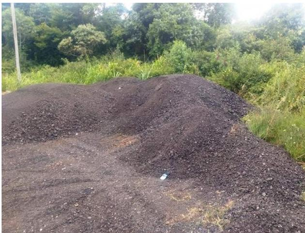
Figura 1. Material fresado estoqueado.
