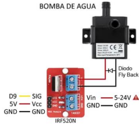
Figura 44. conexión de bomba de agua al IRF520N
