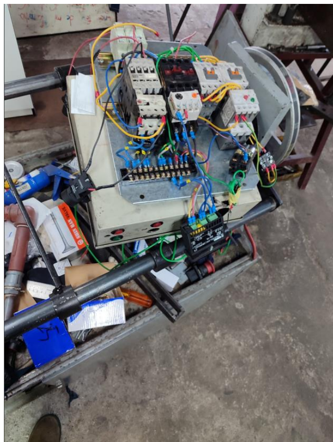
Anexo 13 Colocación de los circuitos en el gabinete
