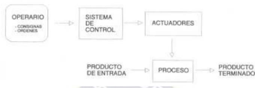
Figura 13. Control lazo abierto [21]
