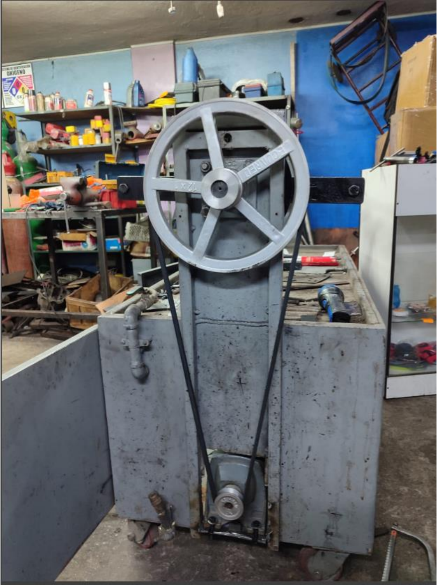
Anexo 10 montaje de la poleas y correa
