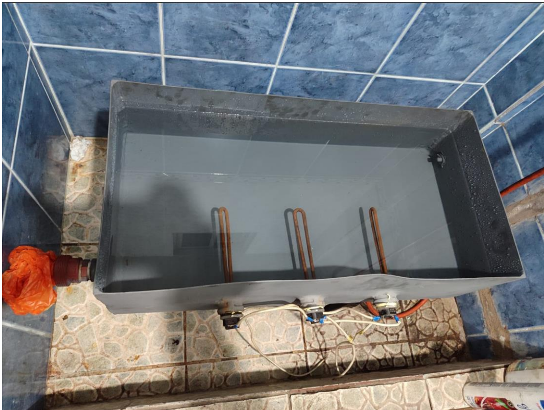
Anexo 9 Comprobación de fugas en el tanque de agua y conexión de las resistencias eléctricas
