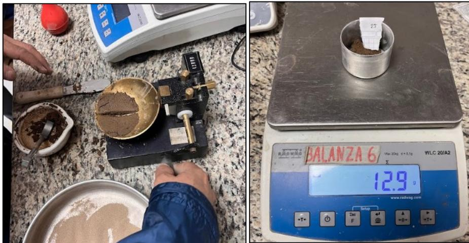
*Ilustración 18. (a) Procedimiento de ensayo en la cuchara de Casagrande; (b) Peso de la porción donde se juntaron los canales.*
