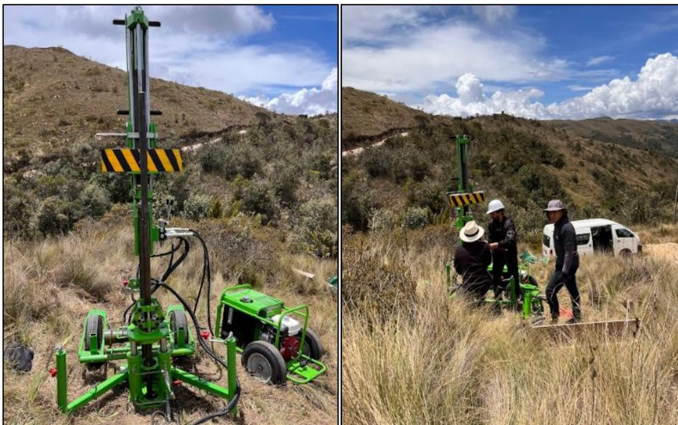
*Ilustración 9. (a) Máquina hidráulica para "SPT"; (b) Ejecución del ensayo "SPT" en la zona de estudio.
