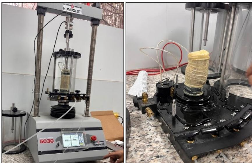
*Ilustración 20. (a) Máquina para ensayo "UU"; (b) Extracción de muestra luego del ensayo.
