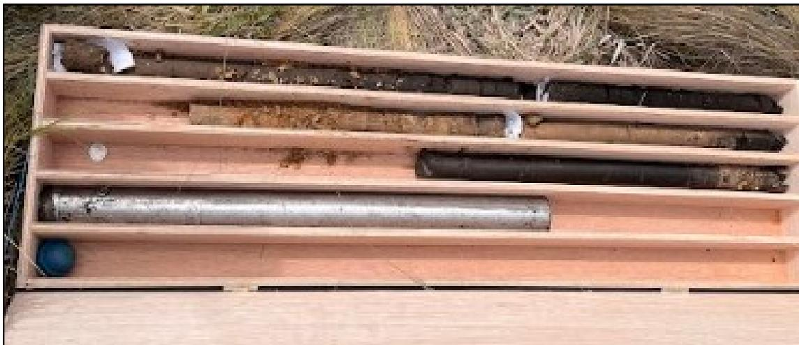
*Ilustración 35. Estratos de suelo extraídos en la caja porta-testigos.
