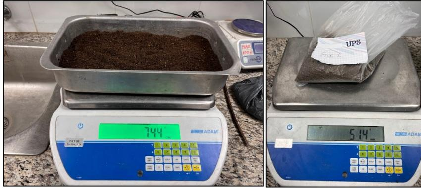
Ilustración 14. (a) Muestra con humedad natural; (b) Muestra luego de secada al horno.
