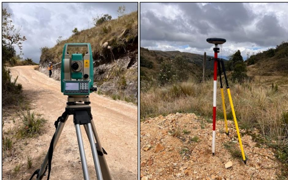
*Ilustración 11. (a) Levantamiento del Talud de falla y sus zonas de vía adyacentes; (b) Levantamiento de punto topográfico referencial.
