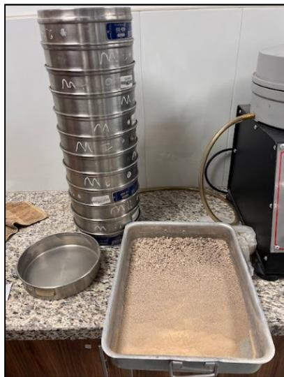
*Ilustración 16. Tamices usados para el ensayo y muestra ensayada.*
