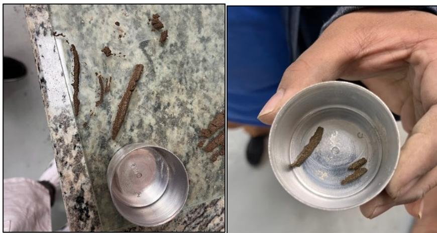
Ilustración 19. (a) Procedimiento de rolado de la muestra de suelo; (b) Colocación de la muestra en envase para pesaje.
