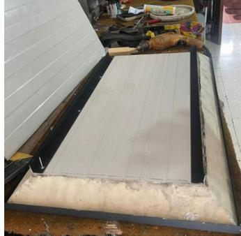
**Figura 36** Colocación de ángulos de aluminio para soporte de cuerpo de cámara
