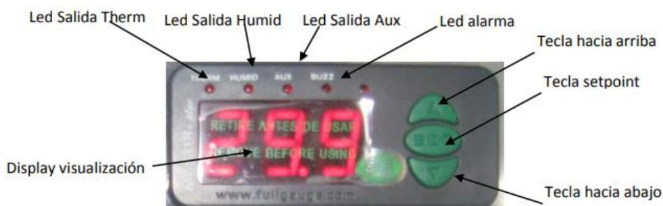
**Figura 47** Partes del controlador
