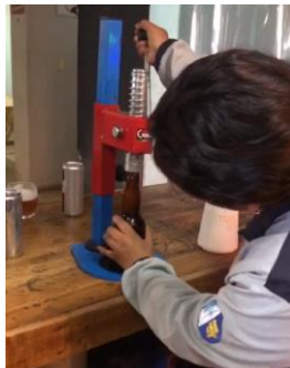
Figura 20 Sellado manual de un envase de vidrio de 330 ml.
