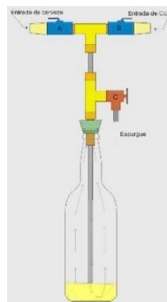
Figura 6 Llenado por contrapresión [19].
