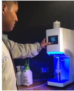
Figura 21 Sellado semiautomático de un envase de lata de 330 ml.
