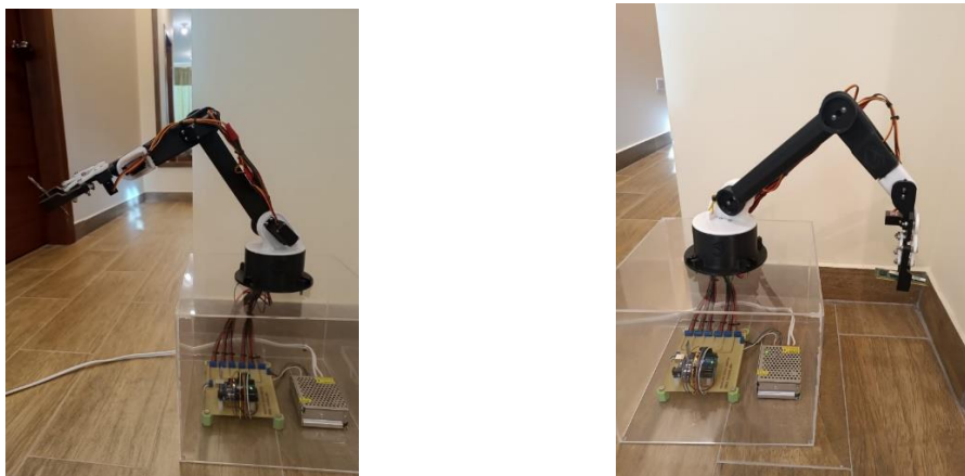
Figura 37. Posición inicial y final de la trayectoria del mecanismo.
