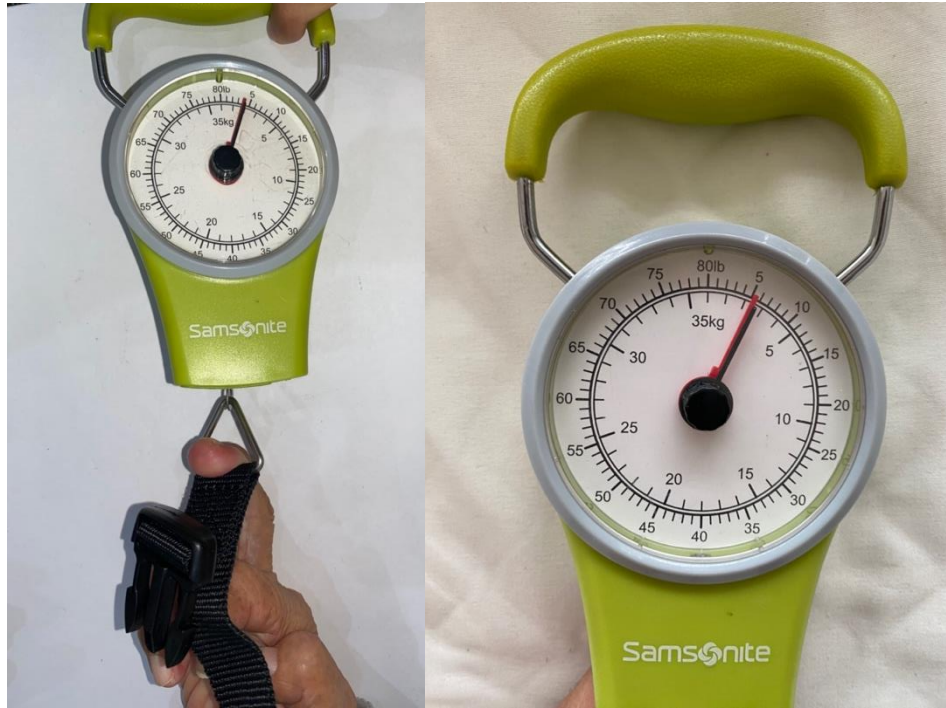
Figura 21. Fuerza para apertura de un dedo.
