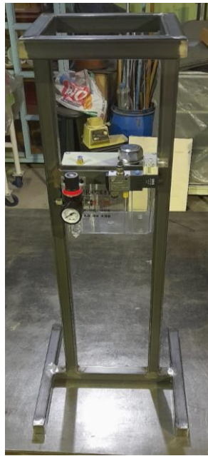
Figura 3-16 Mesa tipo pedestal con depósito de lubricante.
