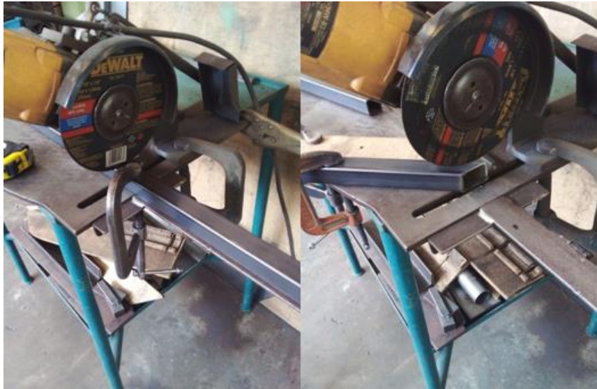
Figura 3-11 Corte de tubo cuadrado 30 x 2mm de espesor.
