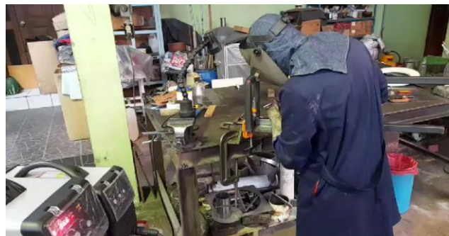
Figura 3-15 Suelda de parantes a la mesa.
