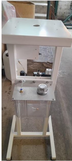
Figura 3-18 Anclaje de depósito y elementos del sistema.
