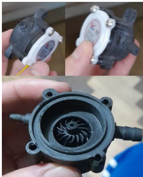
Figura 2-27 Sensor de flujo modificado.
