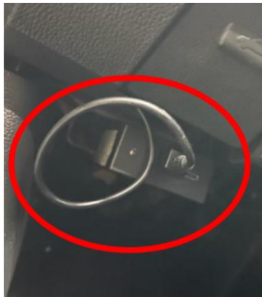
Fig 2.2 Conexión Freematics One+ en Puerto OBD II
