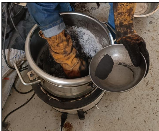
Figura 7. Homogeneización de la mezcla asfáltica con la adición del RHA
