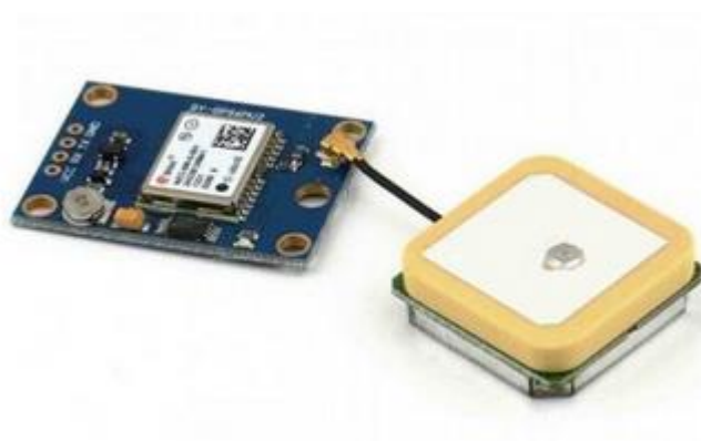
Figura 3: Modulo GPS NEO 6M
