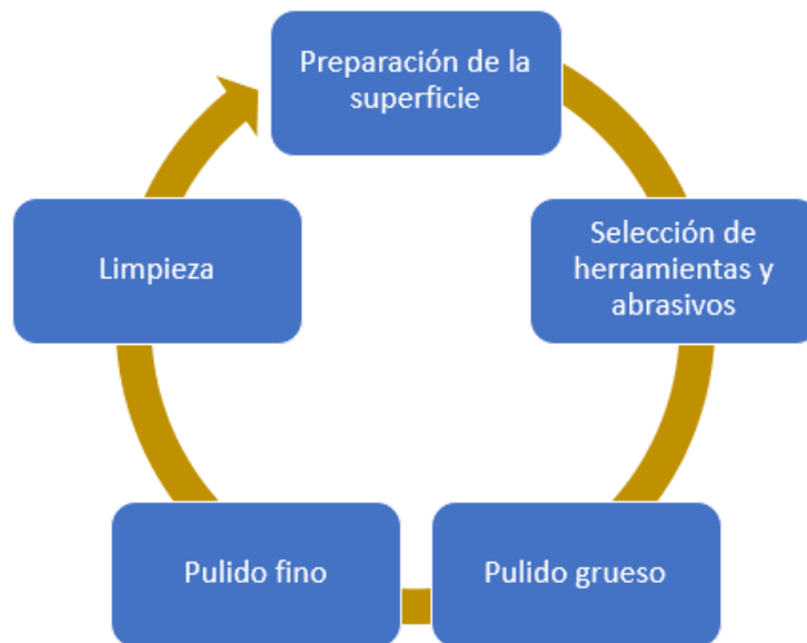
Figura 30. Procedimiento de pulido.
