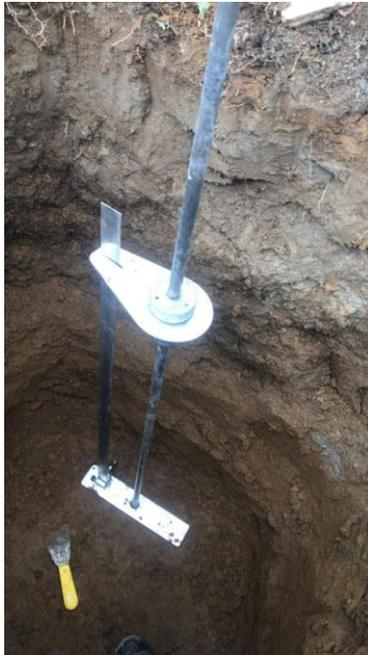
Figura 4. Ensayo DCP in situ de los autores.
