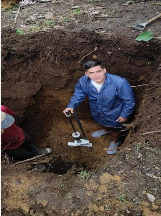
Figura 1. Ensayo DCP in situ ejecutado por los autores.
