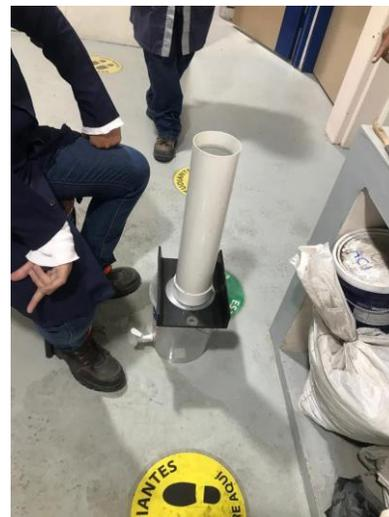
Figura 5. Ensayo permeabilidad artesanal, elaborado por los autores.
