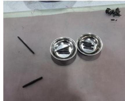
Figura 9. Ensayo Límite Plástico.
