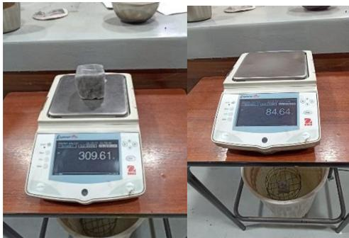
Figura 9. Ensayo Densidad Natural – Método de Parafina.
