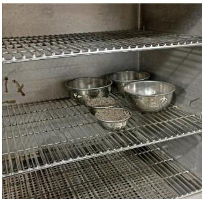
Figura 7. Ensayo de contenido de agua en suelos.
