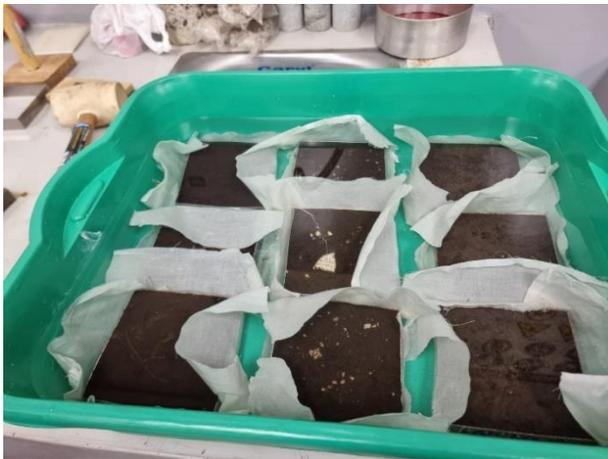
Figura 16. Muestras sumergidas para ensayo de corte directo en estado saturado
