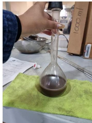
Figura 8. Ensayo de gravedad específica en suelos.
