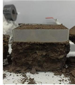
Figura 14. Tallado de muestra de suelo para ensayo de corte directo
