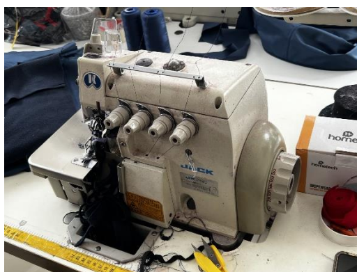
Figura 15. Máquina Overlock de 4 hilos Siruba 700 K.
